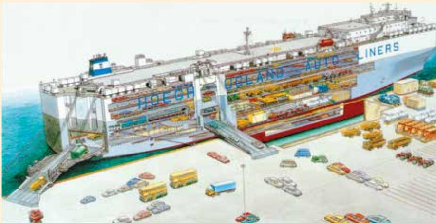
Roll On/Roll Off gilt als die sicherste und kostengünstigste maritime Transportart. Roll On/Roll Off-Schiffe nehmen nur rollende Ladung auf, die über eine Rampe ins Schiffsinnere hineingefahren wird. Moderne Car-Carrier können maximal 6.000 Fahrzeuge von bis zu 6 m Höhe, 9 m Breite, 30 m Länge und 300 t Gewicht aufnehmen. Die Decks sind zum Teil höhenverfahrbar, so dass ein Maximum an Fahrzeugen geladen werden kann.
